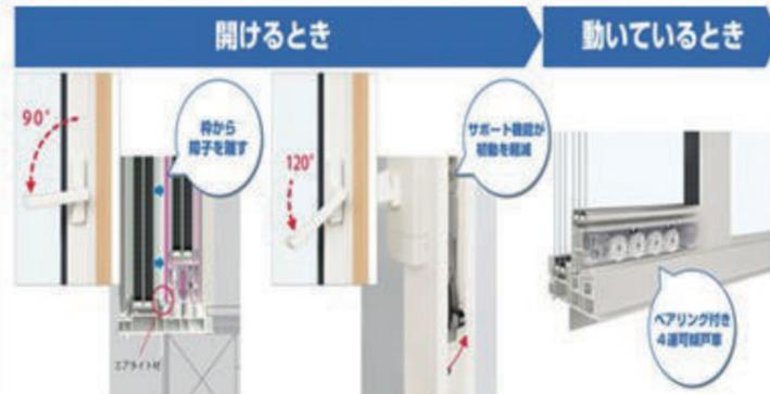
窓を開ける際は、ハンドルを横に倒す(90°)と解錠し、そのまま下げる(120°)とサポート機構が機能するため窓を開ける際の力が軽減され、軽い操作性を実現しました。アルゴンガス入トリプルガラスの性能を最大限に活かす、16mmの空気層と総厚41mmのガラスを採用しています。また、施錠時、室内側に障子を引き寄せ、しっかり密着します。
